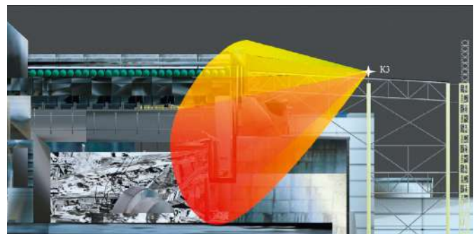
Рис. 5. Кутовий розподіл інтенсивності гамма-випромінювання в точці K3
