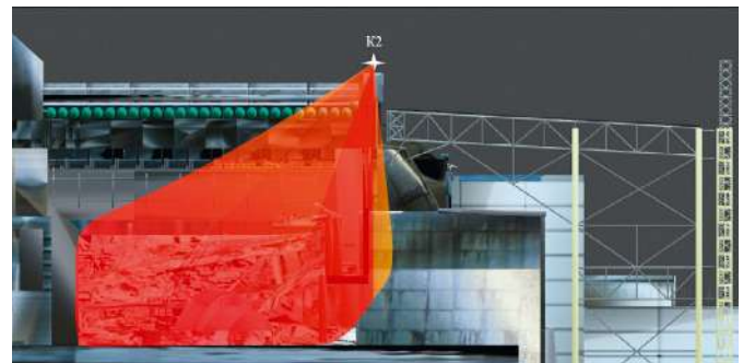
Рис. 4. Кутовий розподіл інтенсивності гамма-випромінювання в точці K2
